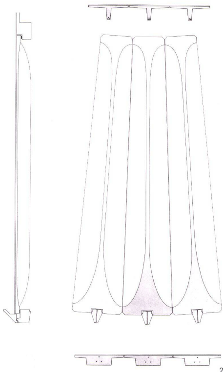
1 Vorgefertigte T-Betonträgerdecke über der Botschafts-Eingangshalle. Plancher en éléments T préfabriqués en béton recouvrant le hall d'entrée de l'ambassade.
