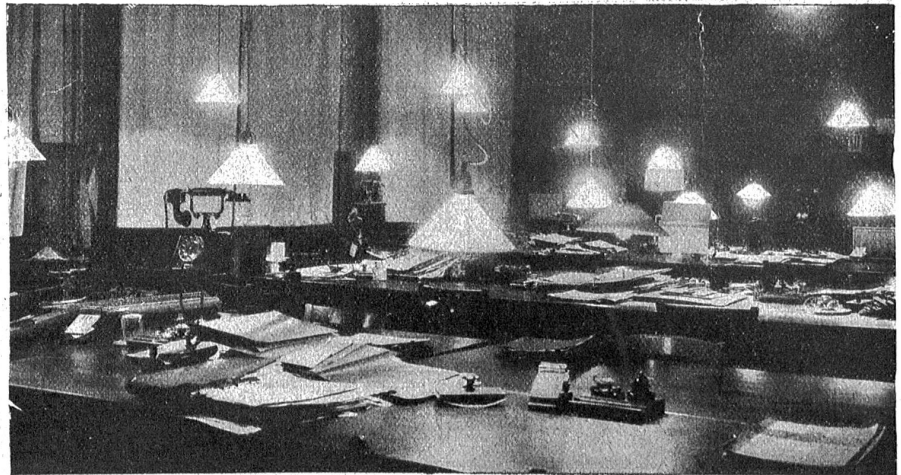
Nach alter Art beleuchtetes Bureau: Die Schreibtische bilden Lichtinseln in dem im übrigen halbdunklen Raum, dem eine genügende Allgemeinbeleuchtung fehlt.
