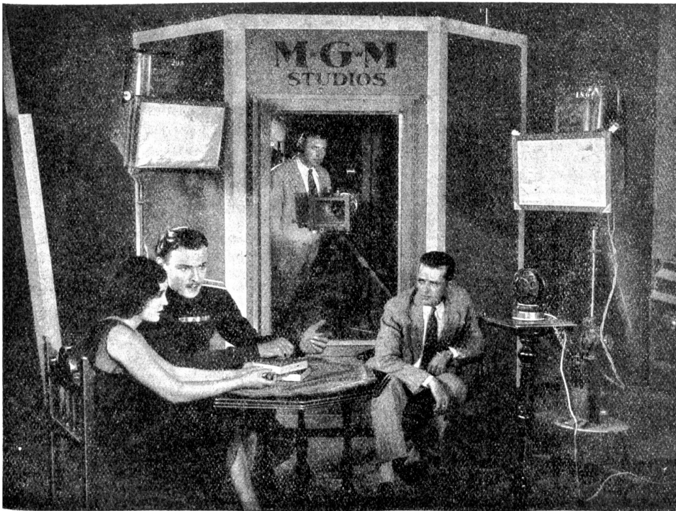
Eine Aufnahme im Confilm-Atelier: Der Kamera-Mann nimmt die Szene aus einem schalldichten Glaskasten auf.
