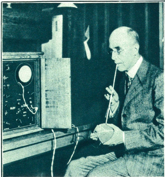
Er hört mit dem Mund. Prof. Bedell sitzt vor seinem Apparat, der den Tauben ermöglichen soll, Musik auf dem Wege durch den Mund zu vernehmen.
