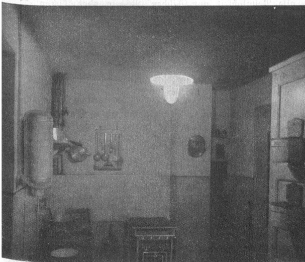
Schlecht beleuchtete Küche; blendendes Licht mit harten und tiefen Schatten. Sonderbeleuchtung über Herd und übrigen Arbeitsplätzen fehlt.
