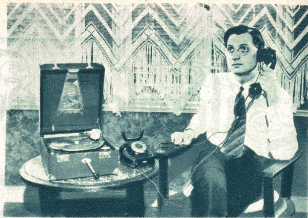
Das Telefongespräch auf der Schallplatte. H. Dillge, Mitarbeiter des Erfinders mit dem neuerfundnen »Teleskriptor«, der jedes Telefongespräch, Rede und Gegenrede, mittels eines Verstärkers und einer Aufnahmevorrichtung auf kleine unzerbrechliche Schallplatten festhält. Man legt den »Teleskriptor« mittels eines Bügels über den Kopf und hält den Telephonhörer statt an das Ohr an die Muschel des Geräts. Photo Wide World, Berlin.
