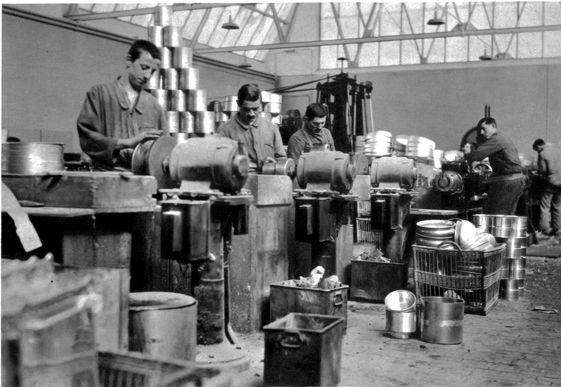
In der Schleiferei. Die egalisierten Hohlgefäße werden auf Spezial-Schleif- maschinen innen fein geschliffen.
