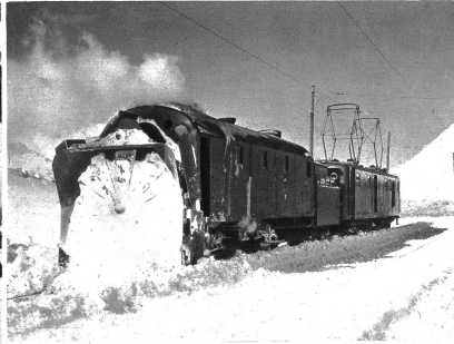
Dampfschneeschleuder der Berninabahn auf Berninapasshöhe, 2300 Meter. Dampfschleuder 600 PS, elektr. Lokomotive 700 PS, nachmal werden 3 Lokomotiven neben der Dampfschneeschleuder verwendet, also total ca. 3000 PS.
