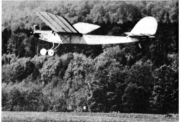
„Motormodell“ mit Zweitaktmotor. Führt Benzin für eine Flugdauer von 40 Min. mit sich. Gewicht 720 Gramm.
