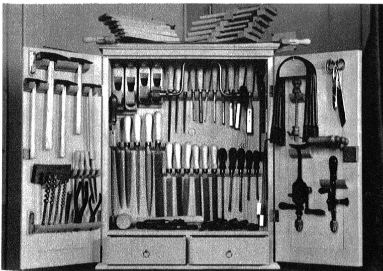
Der Werkzeugkasten: Weniger tuts auch! Die allernotwendigsten Werkzeuge sind: Hammer, Schraubenzieher, Zange, Laubsäge, Sackmesser, Schere, Masstab, Holzfeile, Glaspapier und Wachskerzen. Dies hier ist einer der Musterkasten, welche der Ae. C. S. den Modellbaugruppen, die gut arbeiten, leihweise zur Verfügung stellt.
