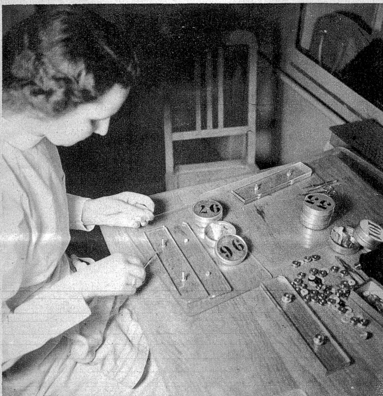
Von jeder Probe werden mit einer krummen Schere möglichst kleine Stückchen in der Längsrichtung der Muskelfaser abgeschnitten und auf eine Glasplatte ausgebreitet. Durch Auflegen und Festschrauben einer zweiten Glasplatte werden die Stückchen durchsichtig düngepresst. Diese ganze Arbeit erfordert eine geschickte, ruhige Hand.
