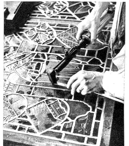
Nach der Abkühlung werden die gebrannten Stücke wieder auf die Scheibenrisse gelegt und können dann mit Bleiruten eingefasst und zusammengefügt werden. Schliesslich werden die Verbindungsstellen der Bleiruten mit Zinn zusammen gelötet und das Glasgemälde ist zum Einsetzen bereit.
