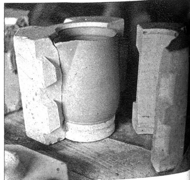
Verfeinerte Modelle werden nicht auf der Drehscheibe hergestellt, sondern sie werden gegossen nach bestimmten Formen.
