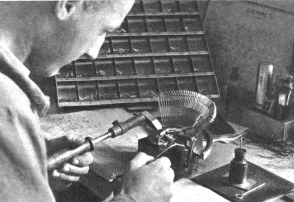
Jede Type muss sorgfältig auf den Hebel gesetzt und gelötet werden
