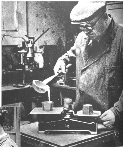
Die Berner Eichstätte. Marktfrauen bringen regelmässig nach Marktschluss ihre Waagen zur Eichstätte zur Kontrolle und Einlagerung bis zum nächsten Markttag. Rechts: Ein neuer Gewichtes „Bett“ wird bis zum annähernden Soll-Gewicht mit Blei ausgegossen. Die genaue Ausregulierung erfolgt auf der Prüfwaage.
