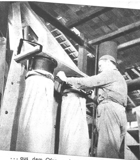
... aus dem Ofen und werden von da direkt in die Mühle transportiert. Aus der Mühle wird das Mehl direkt in die Papiersäcke abgefüllt
