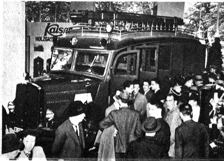
An der Mustermesse in Basel ist die von der baselstädtischen Feuerwehr erworbene modernste Automobilspritze der Schweiz ausgestellt. Sie hat eine Minutenleistung von 3000 l und enthält neben Leitern, Schläuchen etc. auch Gasschutzgeräte und Pulmotor
