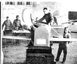
Ausbildung im „Linktrainer“. Hier erlernt der Pilotenschüler das Fliegen nach den Bordinstrumenten, den sogenannten Blindflug. Obschon er in zugedeckter Kabine „fliegt“, kann er vom Fluglehrer genau kontrolliert werden. Am Kommandotisch wird auf einem Blatt der „Flieger“ automatisch aufgetragen. Befehle und Weisungen werden dem Schüler in Telefonie oder Telegrafie übermittelt.
