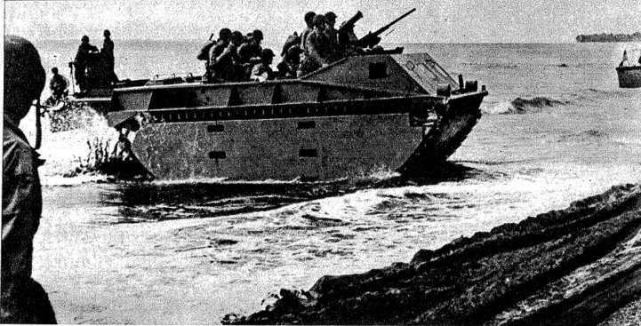
Ein amerikanischer Alligatorentank, wie er eigens für die Invasionstruppen konstruiert wurde
