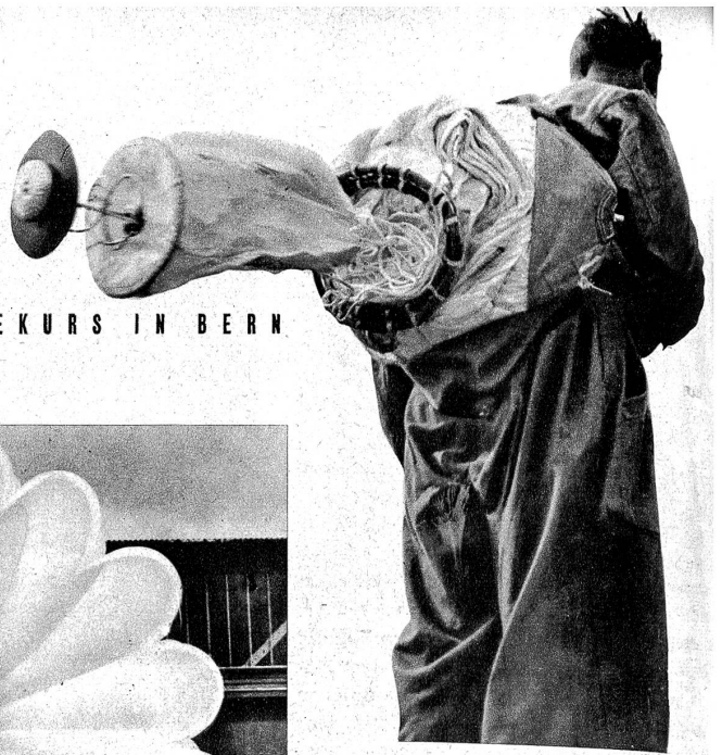
Oeffnen eines Fallschirmes durch Ziehen des Handauslösegriffes. Der kleine Hilfschirm wird herausgeschleudert. Er entfaltet sich und zieht seinerseits den eigentlichen Fallschirm aus dem Fallschirmsack. — Links: Blähen des Fallschirmes im Schraubenstrahl eines Motorflugzeuges, zur Demonstration des vollständigen Entfaltvorganges. — Unten: Besichtigung der Gummikrone in ausgespanntem Zustande
