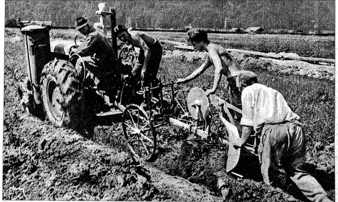
Der Traktor der Firma Hasler AG. an der Arbeit. Der Pflug ist besonders dazu hergerichtet, um noch vorhandenes Wurzelwerk zu zerschneiden. Links: Das erstellte Ökonomiegebäude ist sehr gut eingerichtet und bietet den Anbaufleissigen bequeme Unterkunft Unten: Ein blühendes Kartoffelfeld, das letztes Jahr 55 Tonnen Kartoffeln lieferte
