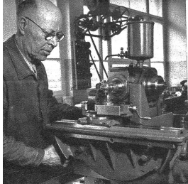
Travaux de fraisage pour pièces d'étampes Stanzstücke werden an der Fraise fertiggestellt
