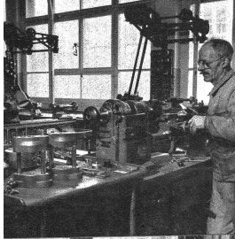
Unten: Usinage et équipement des blocs à colonne pour étampes Stanzblöcke werden zugerichtet
