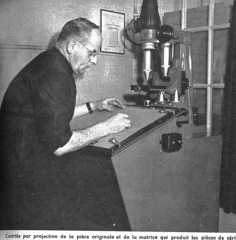
Contrôle par projection de la pièce originale et de la matrice qui produit les pièces de série Projektionskontrolle der Originalstücke und der Matrize für Serienfabrikation
