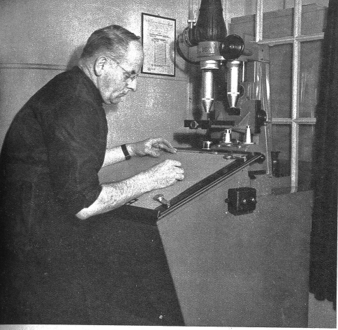
Contrôle par projection de la pièce originale et de la matrice qui produit les pièces de série Projektionskontrolle der Originalstücke und der Matrize für Serienfabrikation
