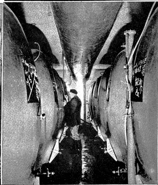
Die grossen Aluminiumtanks im Lagerkeller
