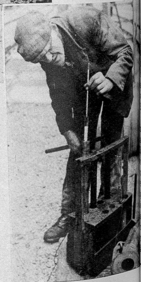
Jeder einzelne Tankwagen wird auf seinen Inhalt kontrolliert, von allen wird ein Muster genommen und das spezifische Gewicht und die Qualität festgestellt und registriert.
