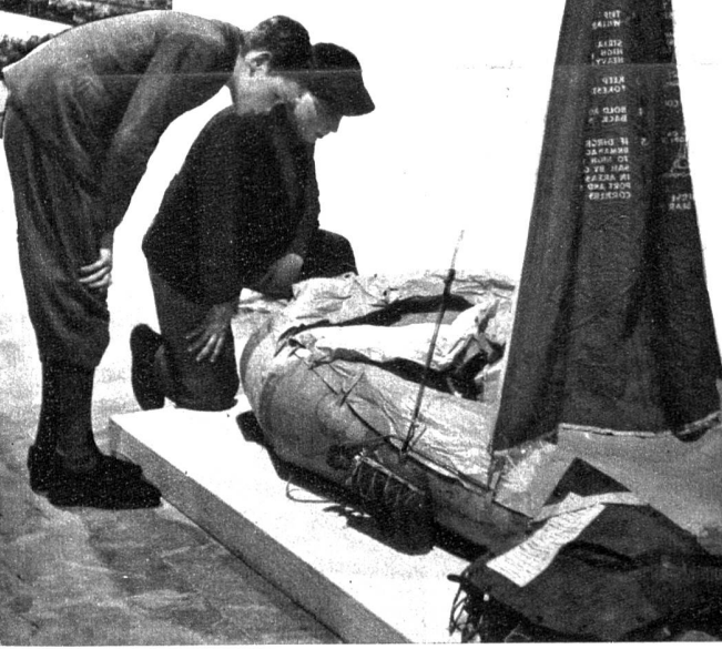
Unten: Ein kleines Rettungsboot, in dem sich 2 Männer tagelang über Wasser halten können. Diese Boote wurden von Flugzeugen über Schiffbrüchigen abgeworfen. Vermittels chemischer Patronen wird der Schwimmkörper mit Luft gefüllt
