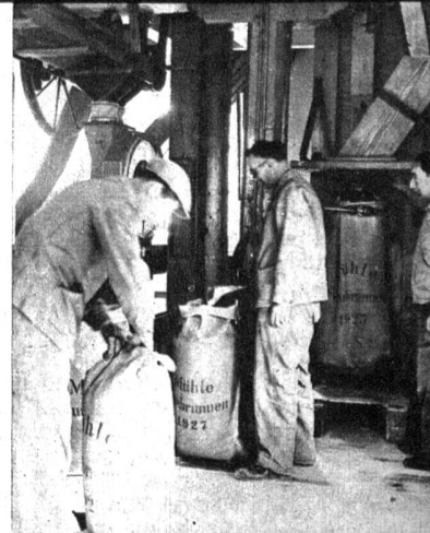
Die Mehlabsackvorrichtung. Das Mehl wird in Säcke gefüllt und zum Abtransport bereitgestellt
