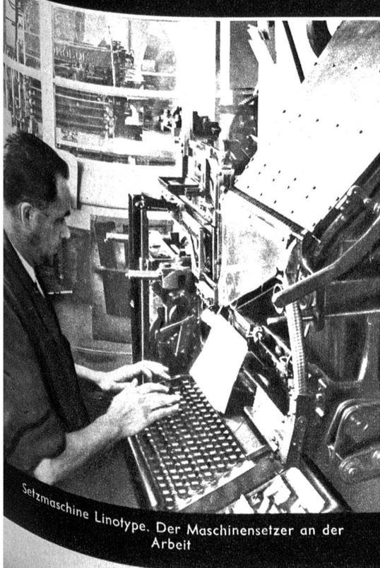
Setzmaschine Linotype. Der Maschinensetzer an der
