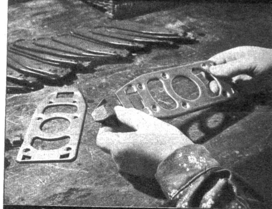
Serienmässige Herstellung der Stahlplatten
