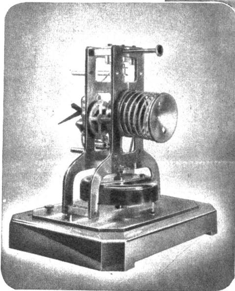
äusserst geringe Abnutzung, die so weit geht, dass man auf Schmieröl gänzlich verzichten konnte. Dieses Fehlen der Oelung hat wiederum die Beständigkeit der Regulierfähigkeit zur Folge. Ausserdem wurde bei der Konstruktion des gesamten Räderwerkes der Atmos danach getrachtet, die Energieverluste möglichst zu verringern. Alle Triebe haben einen grossen Durchmesser, die Zapfen dagegen sind von möglichst geringen Ausmassen.
