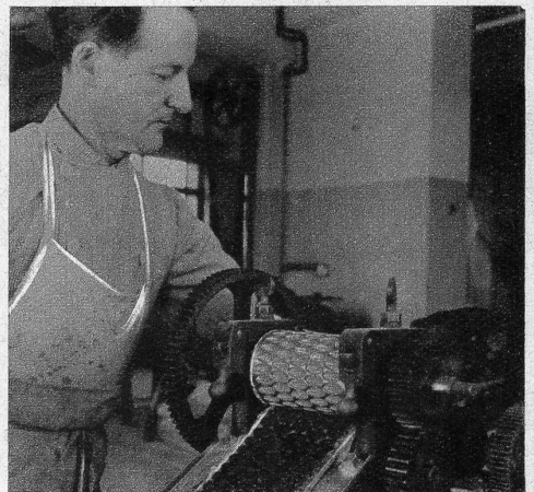
Konfiseriefabrikations-Abteilung. Die heisse Zuckermasse passiert die Walzmaschine. Es werden Sommer- und Winterbonbons hergestellt
