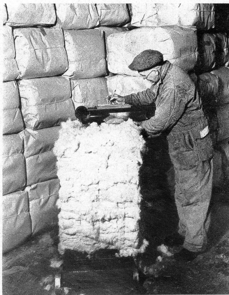
Typha Fluff, wie das Produkt genannt wird, kommt gepresst zum Versand. Ungepresst würde das hier gezeigte Quantum ungefähr den dritten Teil eines Güterwagens füllen
