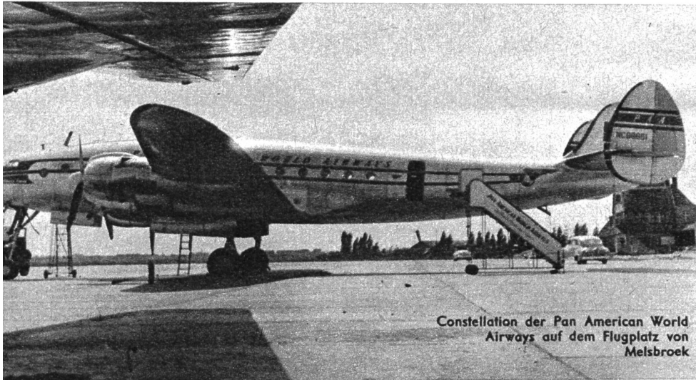
Spannweite 35,81 m, Länge 28,63 m, Höhe 8,41 m, Tragfläche 134,77 m 2 , 6800 PS, Aktionsradius 6920 km, normale Fluggeschwindigkeit auf der Strecke 335 km/h, Vollgewicht beim Start 33 Tonnen. Die Maschine startet nach dem Kongo
