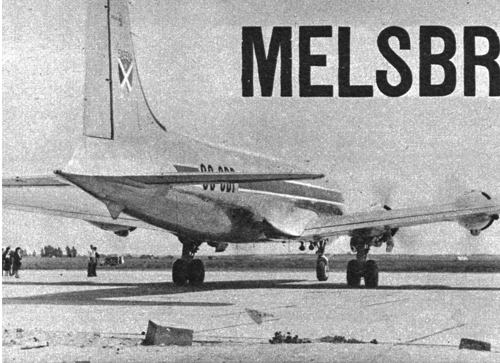
Spannweite 35,81 m, Länge 28,63 m, Höhe 8,41 m, Tragfläche 134,77 m 2 , 6800 PS, Aktionsradius 6920 km, normale Fluggeschwindigkeit auf der Strecke 335 km/h, Vollgewicht beim Start 33 Tonnen. Die Maschine startet nach dem Kongo
