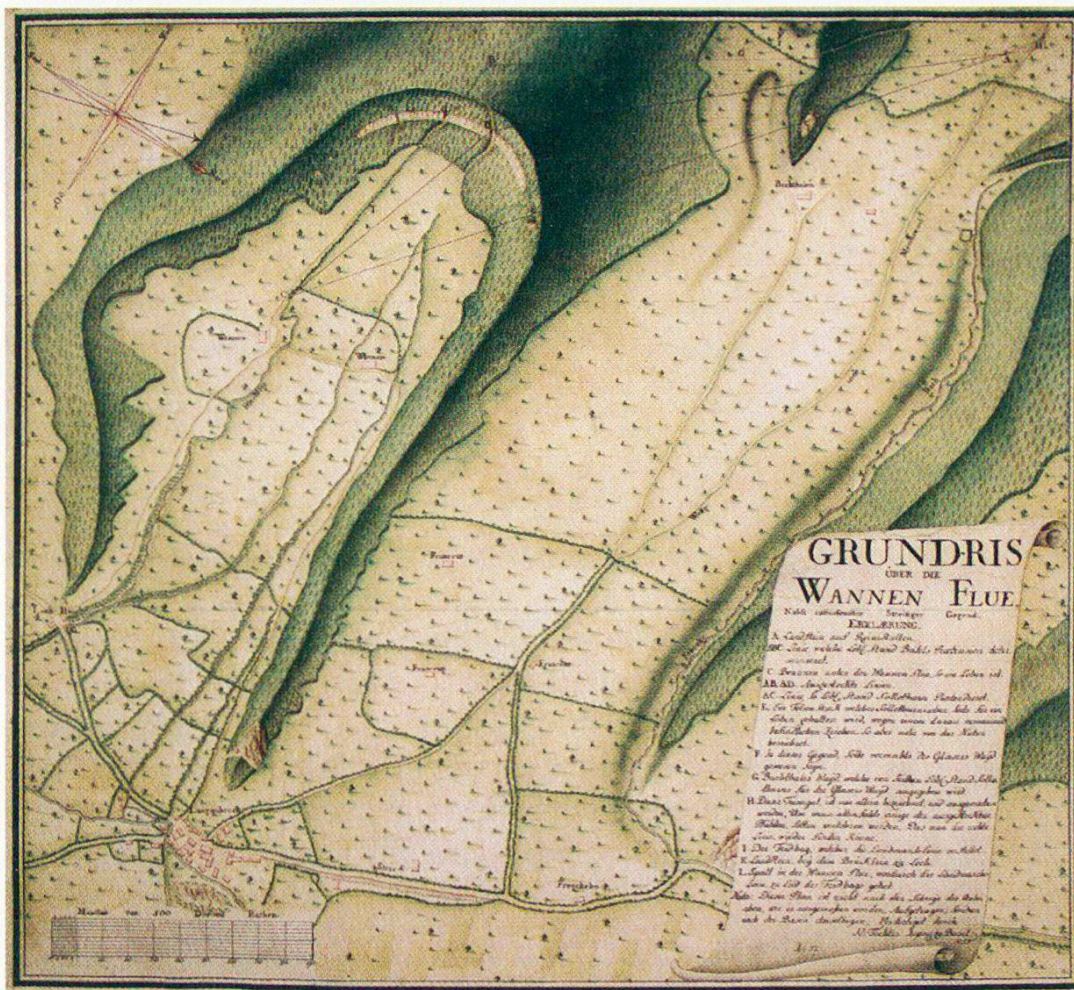
Abb. 7: Der «Grund–Ris über die Wannen Flue, Nebst anstossender Streitiger Gegend», verfertigt 1755 durch Ingenieur Johann Jakob Fechter, gibt die nüchternen geometrischen Resultate aus Abb. 6 in einer anschaulichen Form wieder. Bemerkenswert ist die «Nota: Dieser Plan ist nicht nach der Schräge der Anhöhen, wie es ausgemessen worden, Aufgetragen, Sondern nach der Basin derselbigen».
