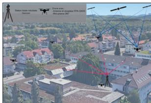
La combinaison station totale robotisée / drone pour des mesures précises sur des terrains difficiles
