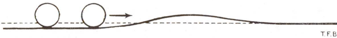
Abb. 1 Schematische Darstellung der „Vorwelle“. Unter der Verkehrslast wird die Geleisebettung heruntergedrückt, während vor der rollenden Last der Oberbau wellenförmig etwas abgehoben wird
