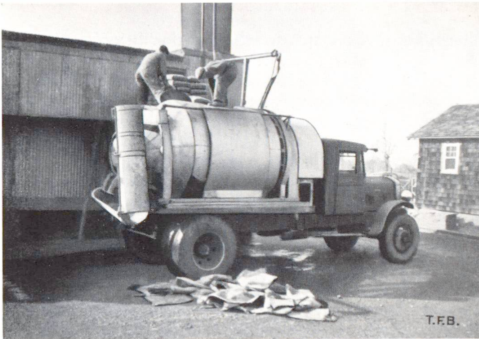
Abb. 6 Transportmischer 3 m 3 . Nach dem Zuwägen des Sandes und Kieses wird der Cement zugegeben und Mischwasser unter Verschluss eingefüllt. Kurz vor Erreichen der Baustelle wird der Mischer in Gang gesetzt
