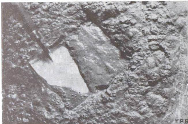
Die Mischung enthält zuviel Sand und Wasser. Obwohl sehr leicht verarbeitbar, können mit solchem Beton keine hohen Festigkeiten und Undurchlässigkeiten erzielt werden
