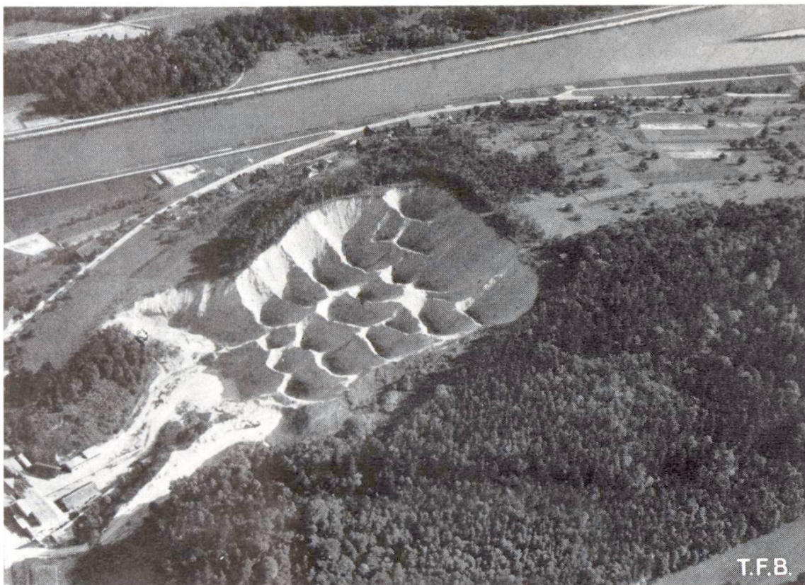
Abb. 5 Flugaufnahme eines Steinbruches mit Rollochbetrieb
