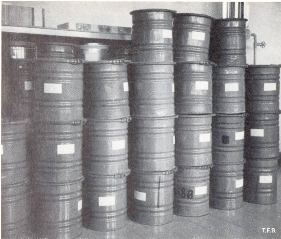
Abb. 4 Gefäße für Cementproben aus Silowagen. Inhalt: 10—15 kg
