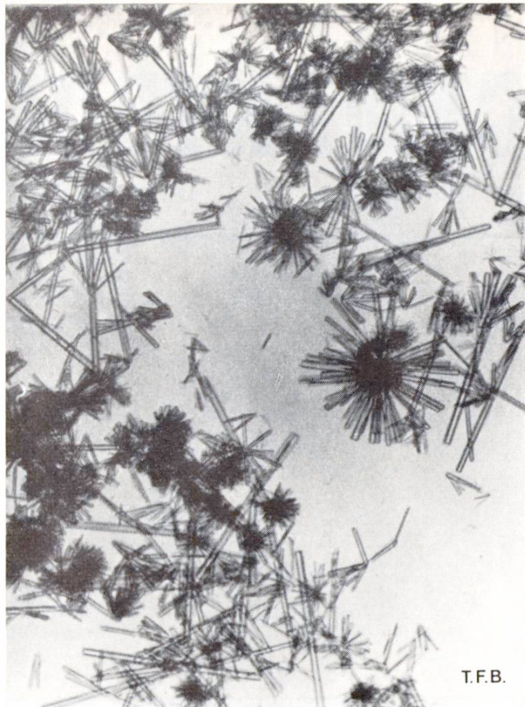
Abb. 1 Ettringitkristalle bei 130facher Vergrößerung (Aufnahme TSH/La)
