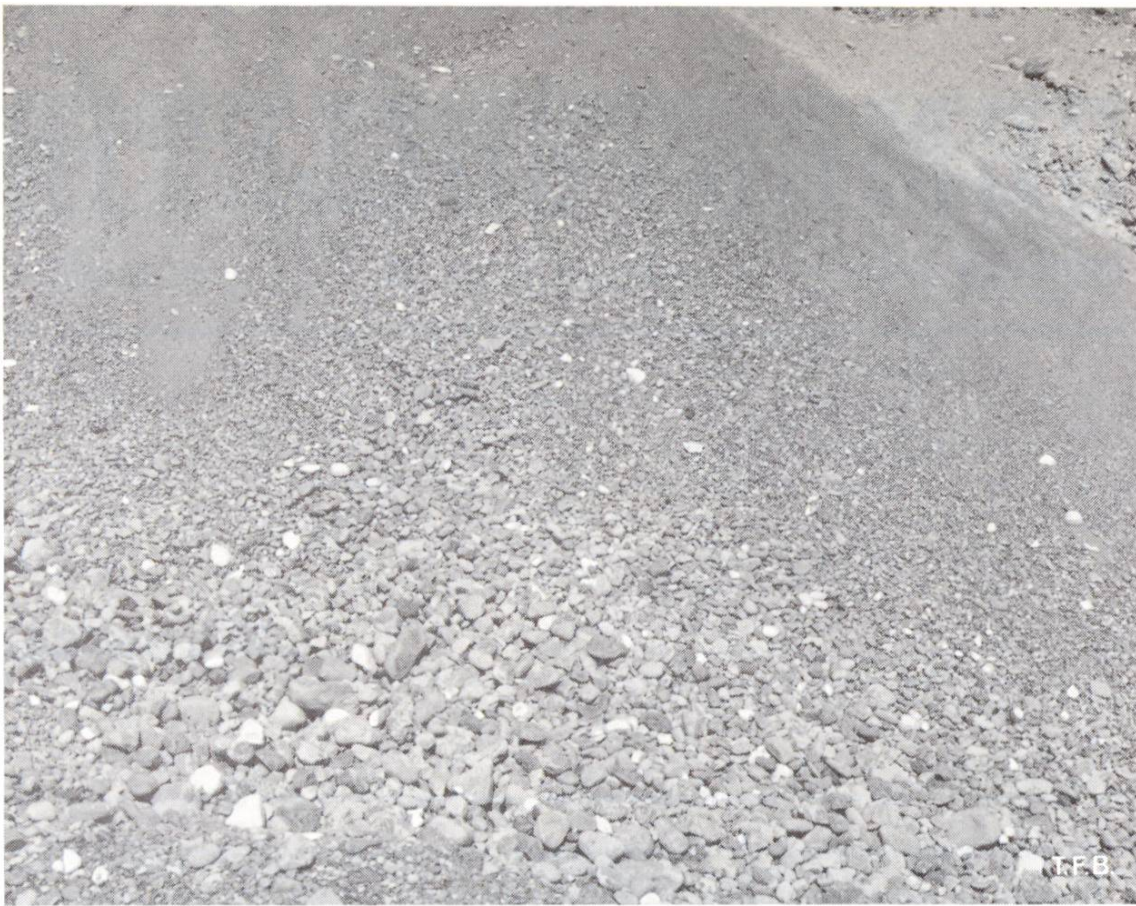
Abb. 1 Entmischung von relativ trockenem Zuschlagsstoff. Wird dieser oft auftretende Effekt nicht beachtet, so entstehen Betonmischungen, die von Fall zu Fall verschiedenen Kornaufbau haben. Die Gefahr der Kiesnesterbildung wird dadurch unter Umständen erhöht
