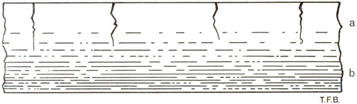
Abb.1 Schwindrisse, entstanden infolge unterschiedlichem Feuchtigkeitsgehalt in den oberen (a) und den tieferen Schichten (b). Die Erscheinung ist häufig zu beobachten bei massigen Stütz- oder Futtermauern sowie an einseitig in der Erde fussenden Mauern. Diese Art der Rissebildung wird oft unterstützt durch bestehende Temperaturdifferenzen.
