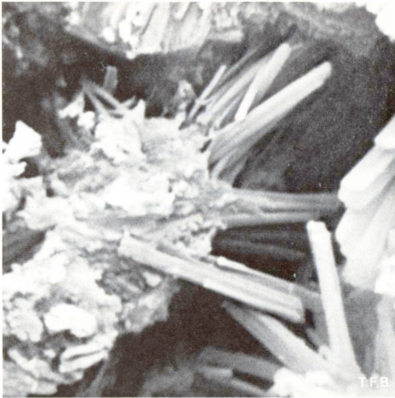
Abb. 3 Detail aus Bild 2 in 11 000facher Vergrößerung. In der Mitte links ein in den Hohlraum ragendes Zementkörnchen, mit weisslichen Hydratationsprodukten ohne gute Kristallformen umhüllt. Von letzteren aus wachsen die Tobermoritkristalle spiessig in den Hohlraum hinein, andere Nadeln wachsen ihnen entgegen, bis schliesslich der ganze Hohlraum filzig verwachsen ist.
