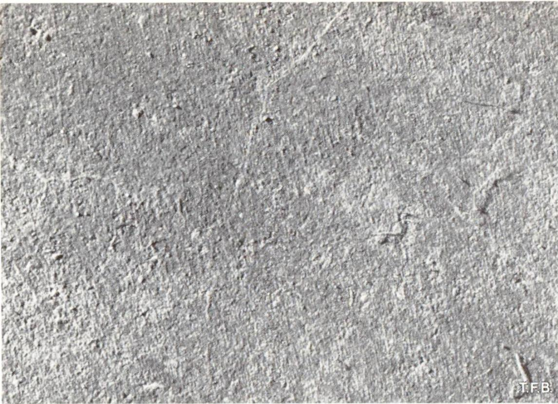
Abb. 2 Sehr feine, zugesinterte Netzrisse in Beton aus glatter Stahlschalung. Vergrößert, Bildbreite = 1 cm, Rissabstand 5 bis 10 mm, Rissweite 0,005 bis 0,01 mm, Risstiefe 0,5 bis 1,0 mm.
