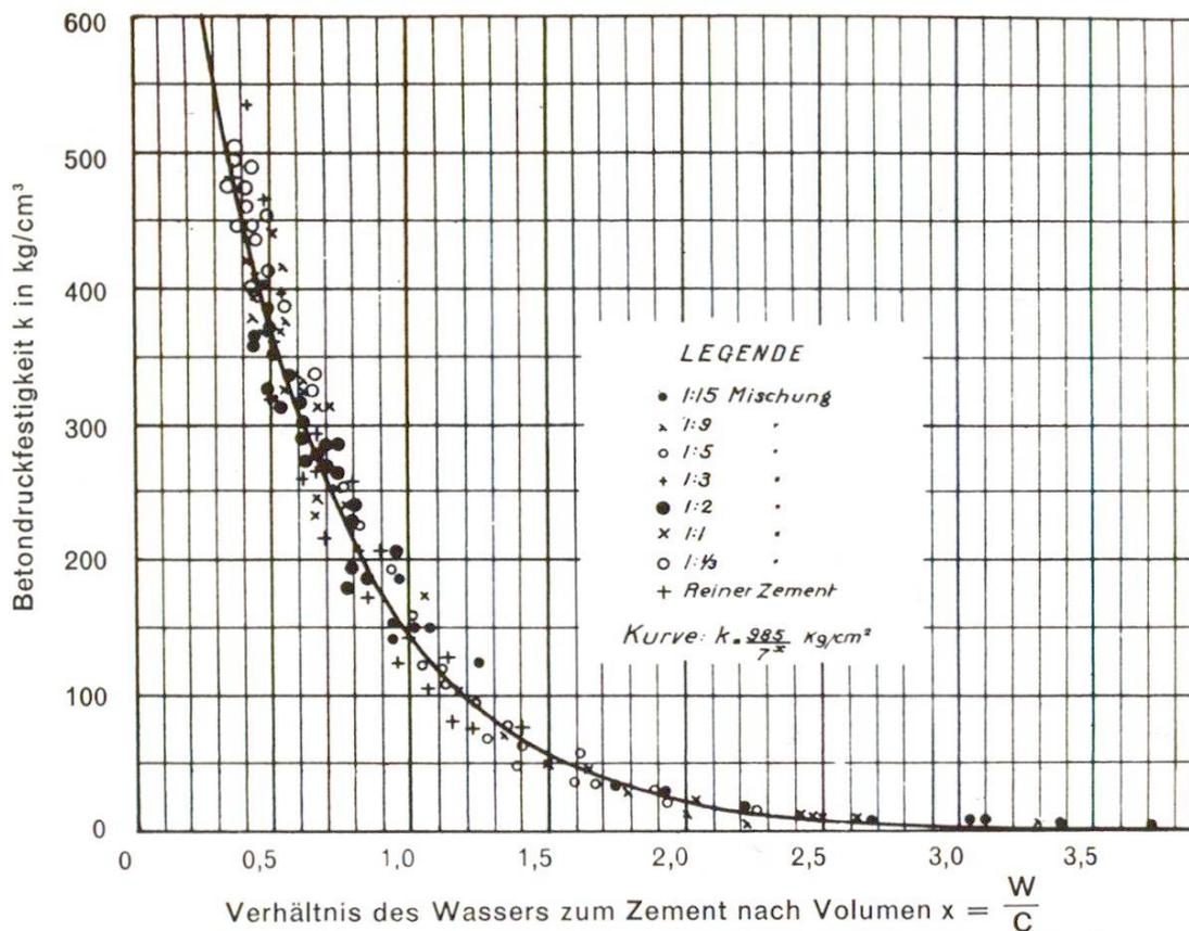
Fig. 1 Beziehung zwischen Betonfestigkeit und Wassergehalt
