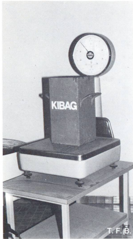
Bestimmung der Frischbeton-Rohdichte
