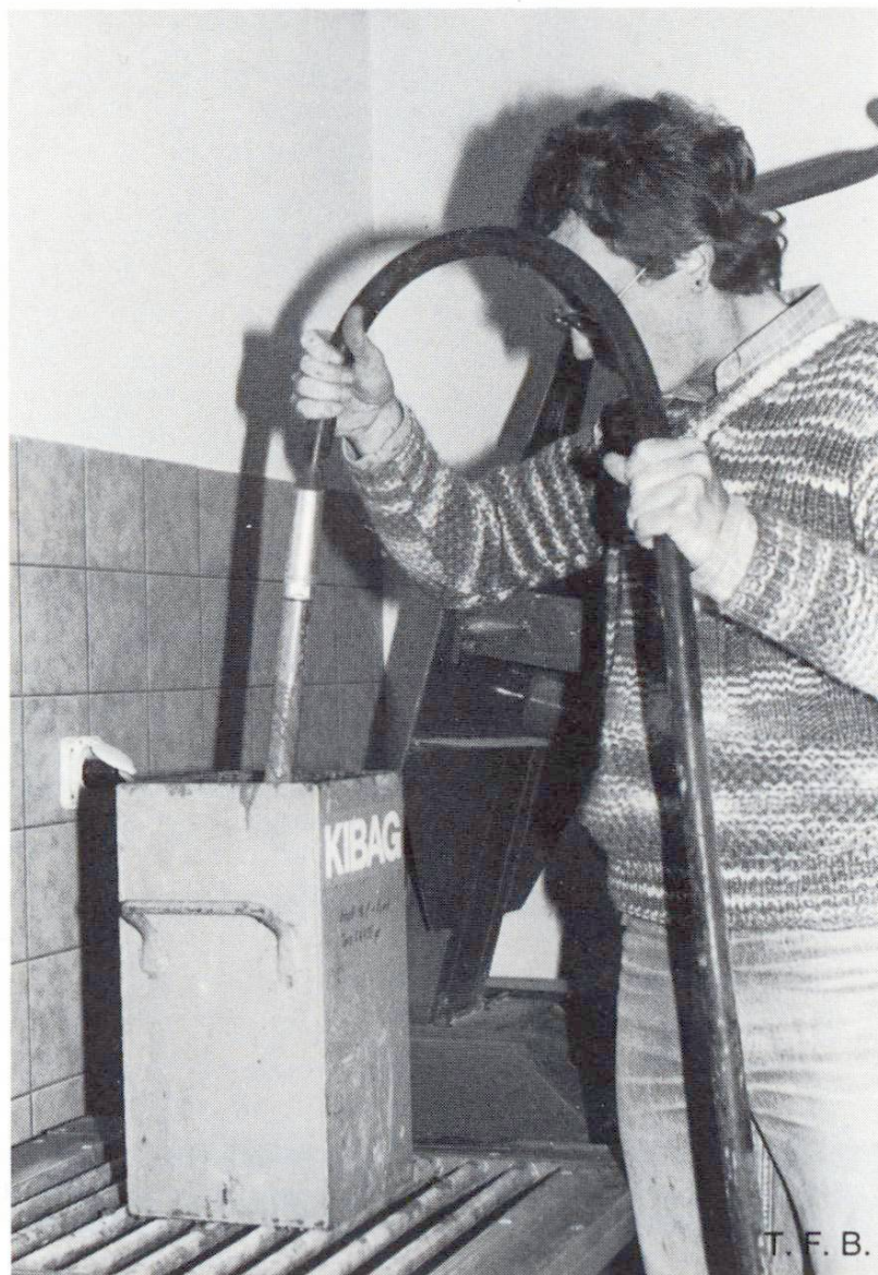
Verdichtungsmass: Verdichten der Probe
