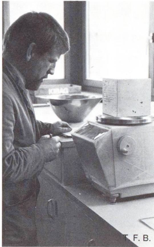
Bestimmung der Rohdichte des erhärteten Betons
