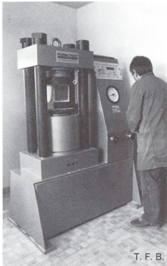
Bestimmung der Würfeldruckfestigkeit
