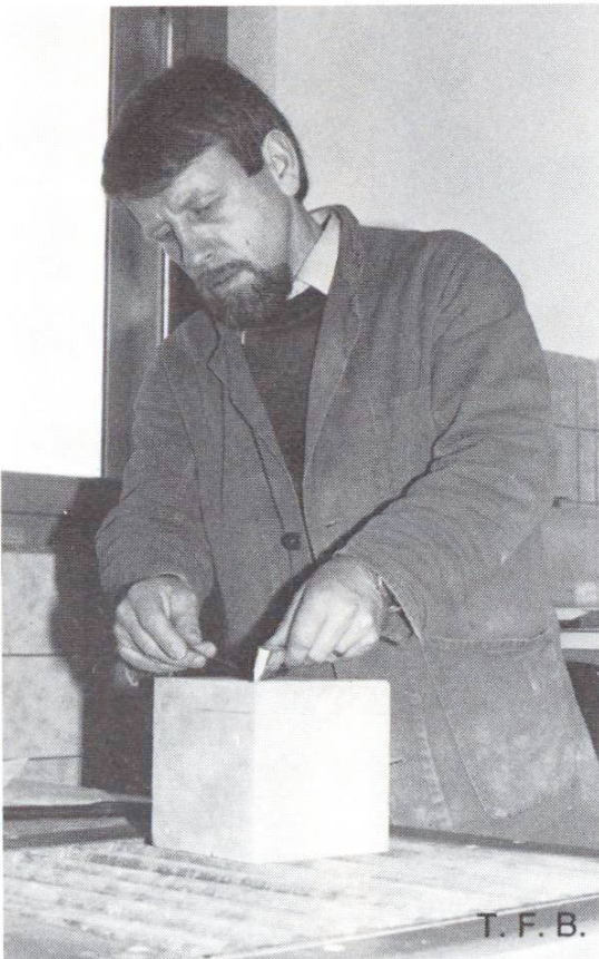
Prüfen der Auflagerflächen auf Ebenheit
