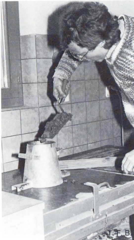
Ausbreitmass: Füllen des Konus
