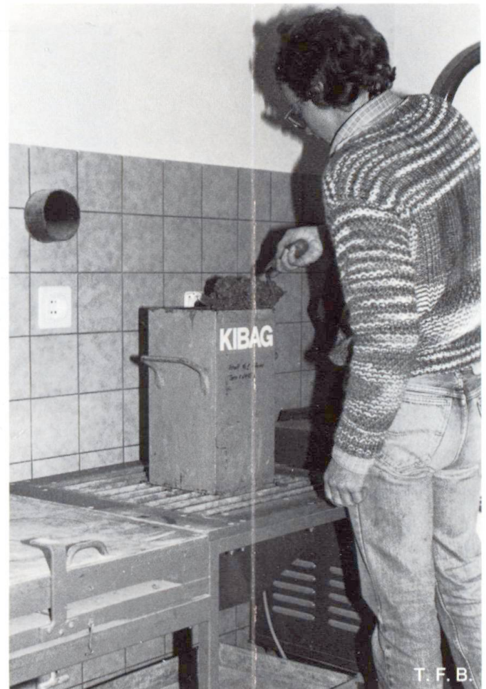
Verdichtungsmass: Füllen des Normalbehälters
