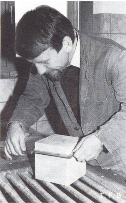
Ausmessen eines Probewürfels zur Volumenbestimmung
