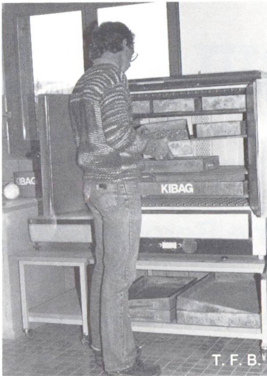
Trocknen von Zuschlagsproben vor dem Aus-sieben
