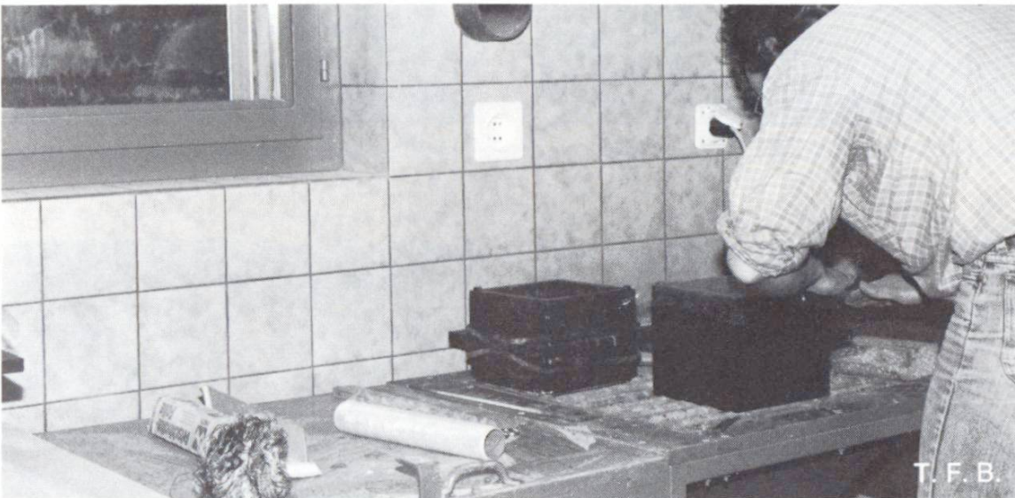
Fertigen eines Probewürfels in einer Plastikform
