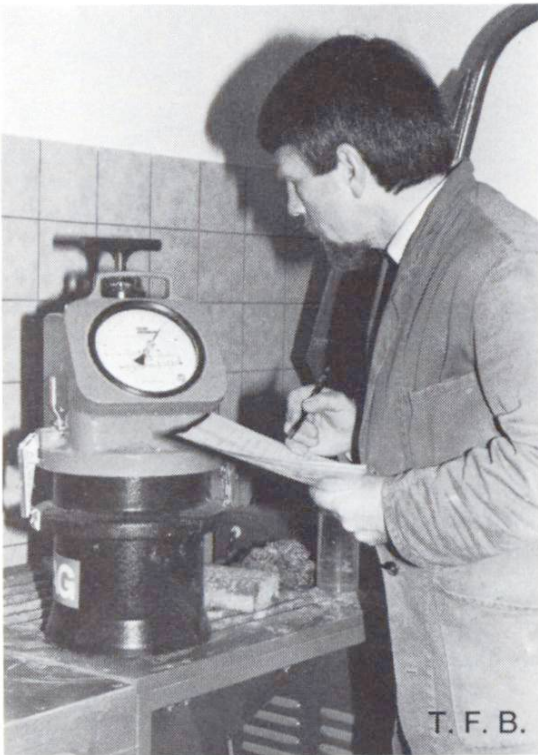
Bestimmung des Luftporengehaltes von LP-Frischbeton
