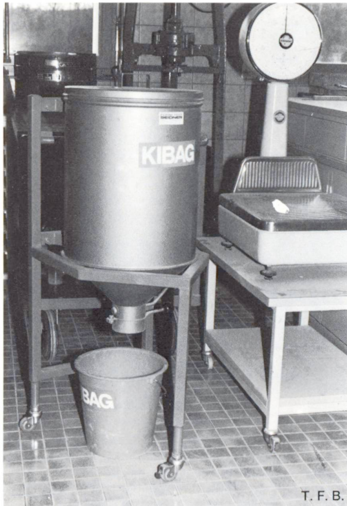
Laborsilo für Zuschlagsmaterial und Waage für Probemischungen
