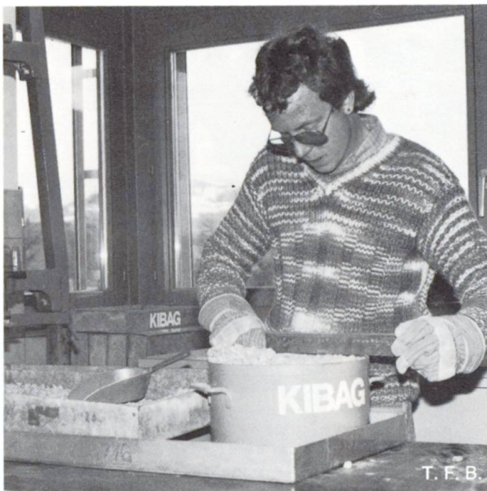
Bestimmung der Schüttdichte einer Zuschlagsprobe
