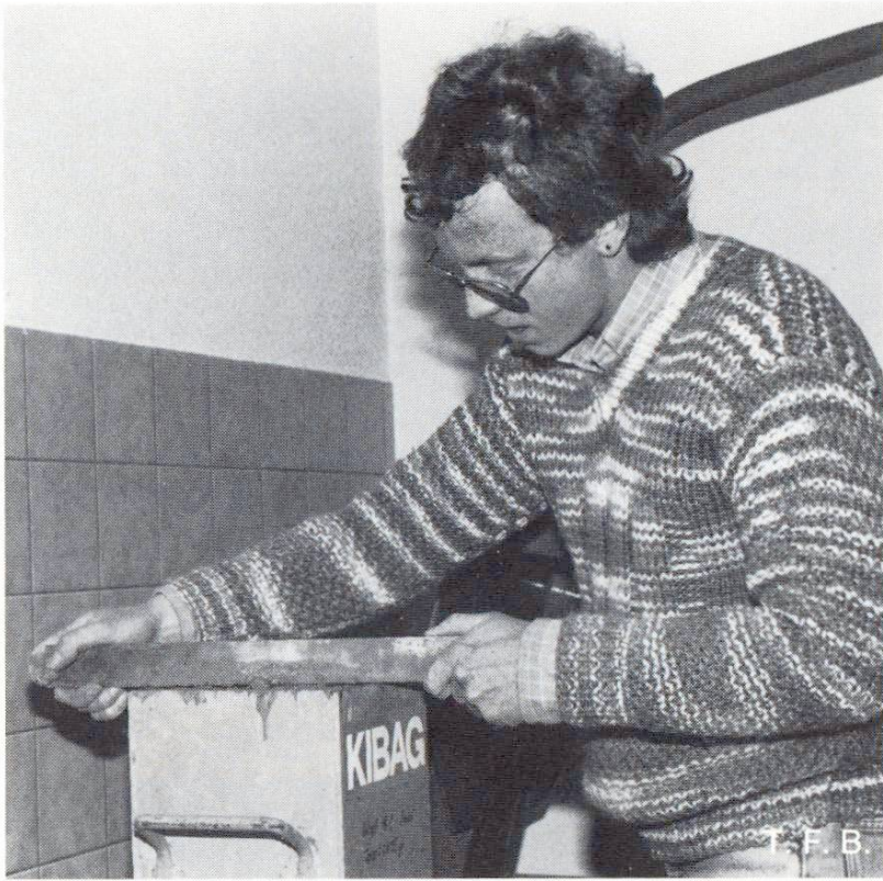
Verdichtungsmass: Abziehen des gefüllten Behälters
