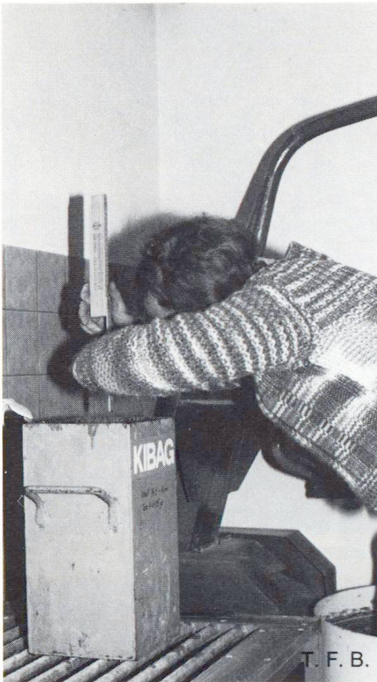
Verdichtungsmass: Messen der Absenkung
