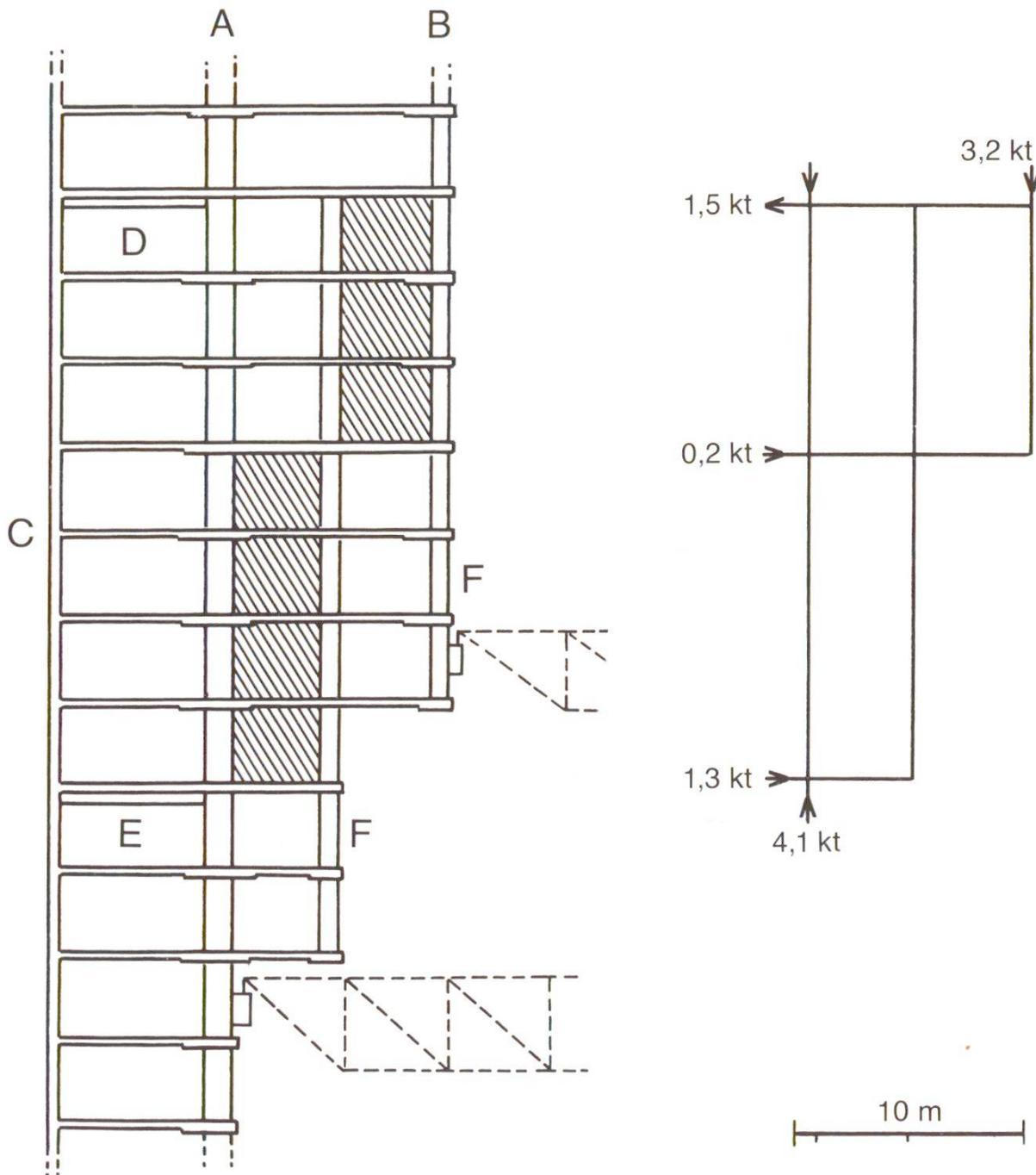
Abb. 2 Anordnung der kraftumlenkenden Zwischenwände im 9. bis 15. Geschoss.
