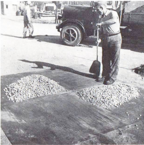
Abb. 5–8 Probenteilung nach der Viertelmethode.
