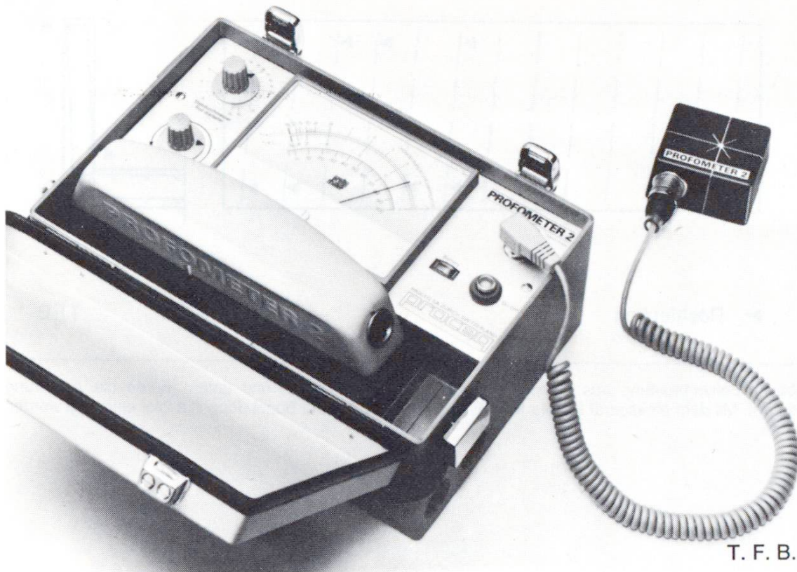
Abb. 1 Elektromagnetisches Armierungssuchgerät. Angeschlossen ist die Punktsonde. Links die beiden Drehknöpfe für die Wahl des Stabdurchmessers und für den «Nullabgleich».
