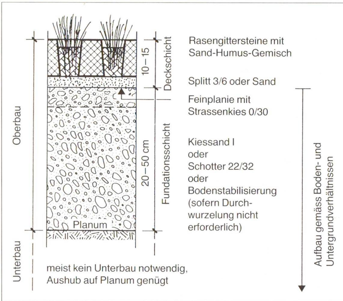
Abb. 1 Aufbau einer befahrbaren Fläche mit Rasengittersteinen (Bezeichnungen aus SN 640 302 a).
