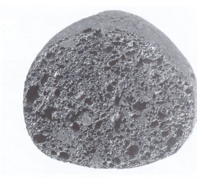
Schnitt durch ein Blähtonkorn (Durchmesser ca. 20 mm).
